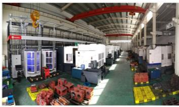
进口高精度卧加柔性生产线
