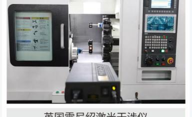
英国雷尼绍激光干涉仪
