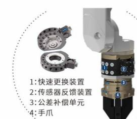
快换手爪操作简便，缩短换产时间，手爪更换可在数秒内完成。
