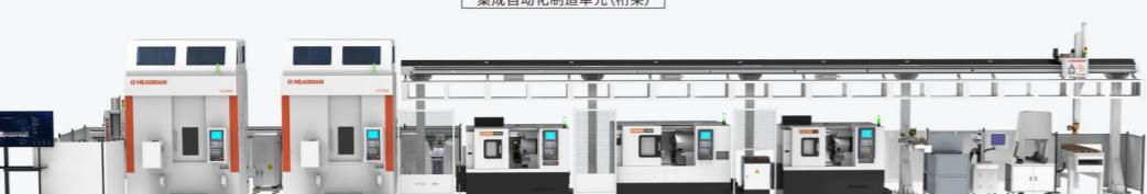
标准自动化制造单元(桁架一体机)
