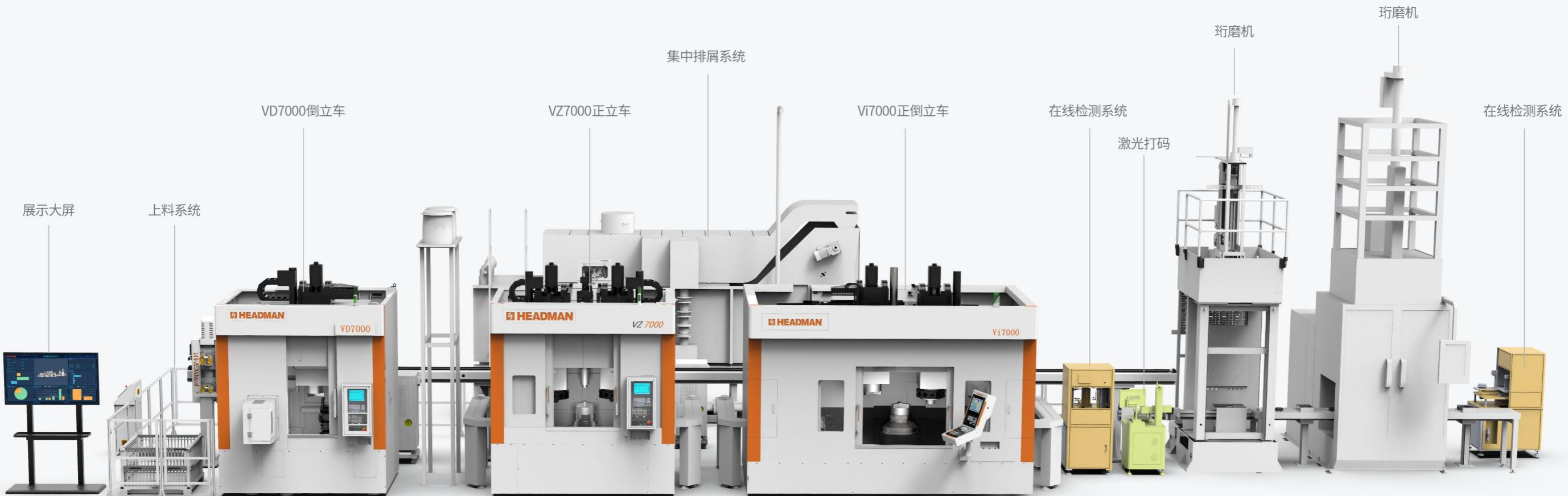
MES系统展示 ▶ 自动上料 ▶ OP10 ▶ OP20 ▶ OP30 ▶ 正倒主轴对接 ▶ 在线检测-内径检测 ▶ 打标 ▶ 珩磨机 ▶ 在线检测-外径检测
