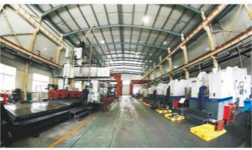
高精度大型五面体龙门加工中心
