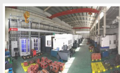
进口高精度卧加柔性生产线
